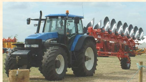
Tractor și plug cu șapte brăzdare de mare performanță (după www.deepingsonline.co.uk ).
