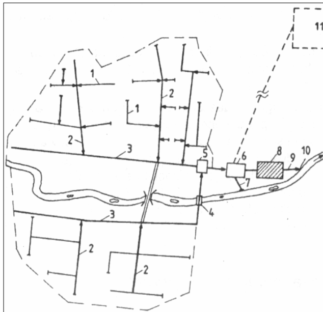
Fig. 247. Schema generală a unui sistem de canalizare (după V. Rojanschi, Florina Bran, Ghiorghita Diaconu, 1997): 1. Canale de serviciu (secundare); 2. Colectoare secundare; 3. Colectoare principale; 4. Sifon inversat; 5. Camera de intersecție; 6. Camera deversorului; 7. Canal deversor; 8. Stație de epurare; 9. Canal de evacuare; 10. Gură de descărcare; 11. Câmpuri pentru valorificarea nămolurilor.
