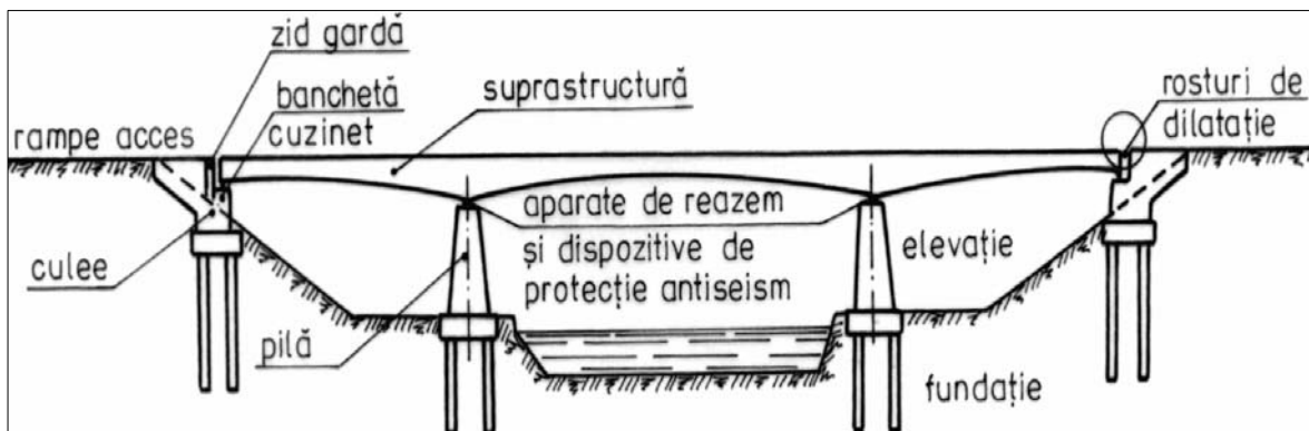
Fig. 141. Vedere laterală a unui pod - elemente componente.
